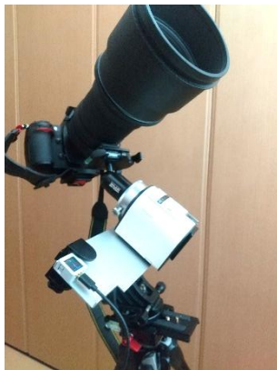
① アルミ板と樹脂製クランプにより固定
